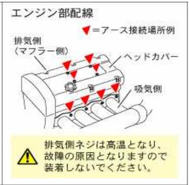
複合ケーブルの追加アースは通常電線に比べ導体外周面を2.5倍とし、イグニッションコイルに発生する特有の高周波の通電性を高め電圧損失を減少させることで着火速度が向上し、燃焼時のイオン化が促進されエンジントルクや燃費などが向上します。(特許出願済)
