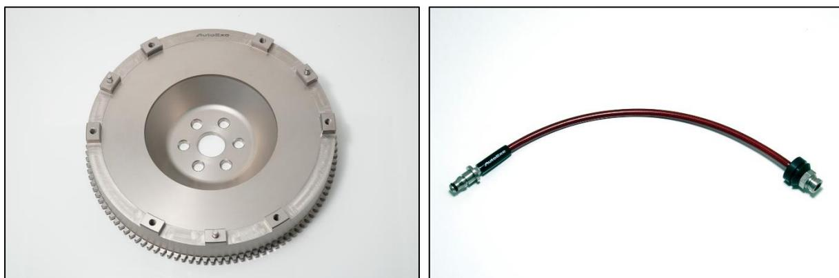
株式会社オートエクゼ(代表:寺田陽次郎)は、「スポーツフライホイール」、「スポーツクラッチライン」にマツダ・ロードスターRF(NDERC-300001～)用を追加設定し、オートエクゼ商品取扱店などを通じて発売する。「スポーツフライホイール」は、量産のデュアルマスをシングルマス構造に変更。素材に強度と耐久性に秀でたクロームモリブデン鋼を採用。慣性モーメントを28%低減するなどスポーツ走行に最適な仕様としている。「スポーツクラッチライン」は、量産品のゴム部分をステンレスメッシュ PTFE(テフロン)に変更し、油圧による膨張を抑制。クラッチのフィーリングの向上に寄与する。また、ホース部に PVC コーティングを施し、耐久性に考慮している。
