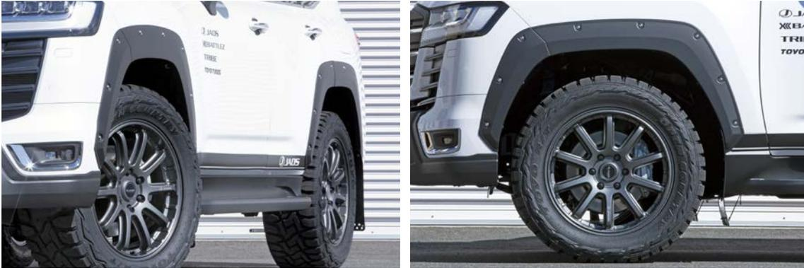
「JAOS フェンダーガーニッシュ type-X」は、片側10mm未満というタイトなサイズながら緻密なデザインによって存在感を発揮します。車体へボルト留めしたように見える部分は、ボルトヘッドをイメージしたオリジナルダミーボルト。フェンダー表面に穴を開けることなく装着することができます。「JAOS フロントバンパーガード」、
