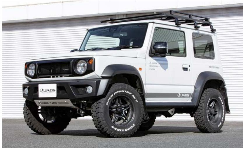
ご好評いただいているジムニー JB64系、ジムニー シエラ JB74系用「JAOS フロントグリル」「JAOS ボンネットディフレクター」「JAOS リヤハッチパネル」のデザインはそのままに、カーボン調を新たに追加しました。本体に使用しているAES樹脂は、ABS樹脂の特性である剛性・耐衝撃性・耐熱性に加え、耐候性も併せ持つことにより未塗装のまま装着していただけます。また、カーボン調の織柄が入ったAES樹脂を成形することで、プレスラインにリアルな表情を与えると同時にスポーティな印象に仕上げます。
